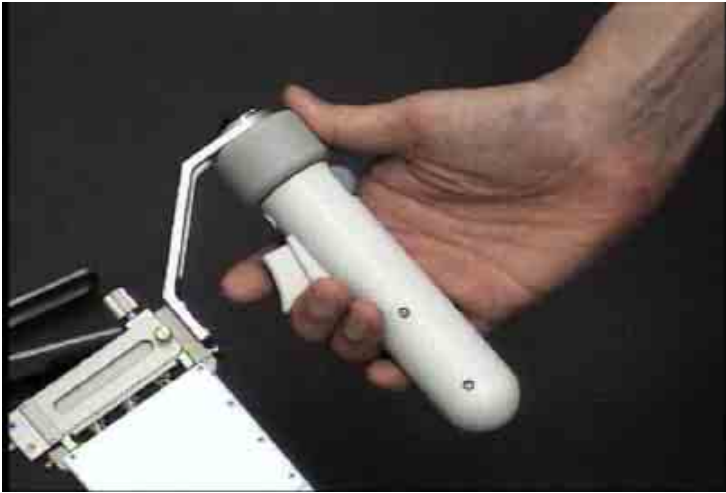
Fig. 2. 同マスタ部分. 術者の片手で先端部分の yaw, roll および gripper 動作が可能.
