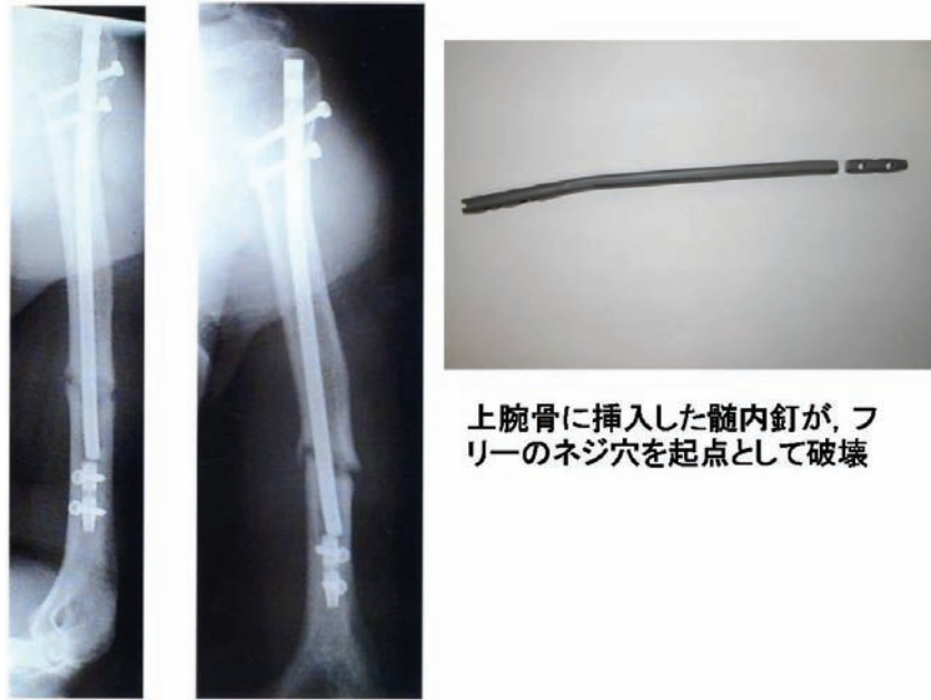
図 a. 上腕骨内に挿入した髓内釘の破壊
