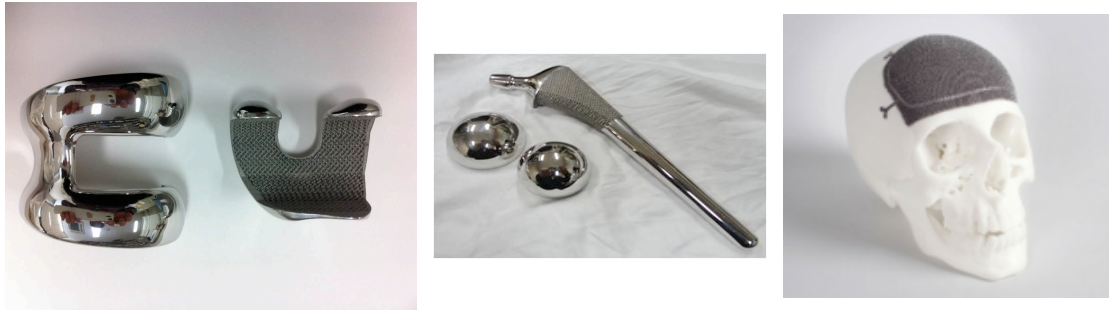
図1 EBM造形を用いて作製したインプラントの例
