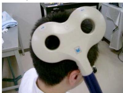
本装置は世界中で広く臨床研究が行われている。治療的な使用では反復して脳に刺激を与えることで脳の興奮性を変化させることができ、治療効果を生む。1 Hz 以下の場合を低頻度刺激、1 Hz を超える場合を高頻度刺激と呼ぶ。また、theta burst stimulation (TBS) や quadripulse stimulation (QPS) といったパターン刺激法も研究されている。コイルの形状は平円形、8 の字型、ダブルコーン (double cone) 型などがある。刺激の限局性にすぐれる 8 の字型コイルが用いられることが多い (写真)。
