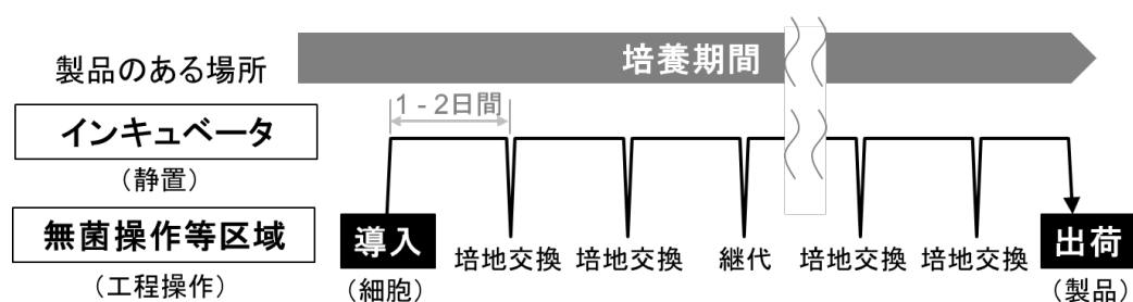
図1 容器を開放して無菌操作を行う再生医療等製品製造の運用事例
