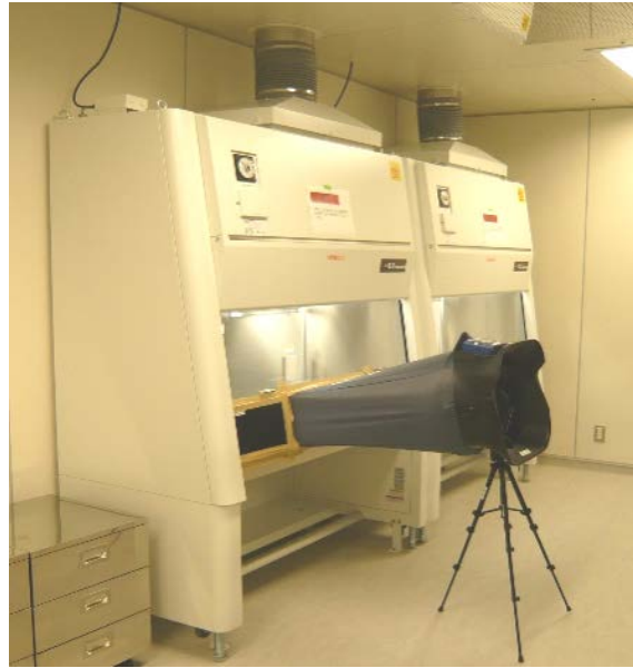
図 3.3 : 流入風速試験（DIM 法）
